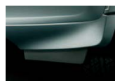
フロントスプラッシュガード 水たまりに進入したときなどに、前方への水しぶきを防止します。
