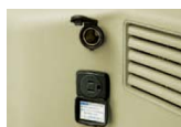
ACパワーサライ（AC100V・最大100W） ＆アクセサリーケット（DC12V） ロゴのリヤクォーターに設置。 （ACパワーサライはSUPER EXCEED、EXCEEDに標準装備）
